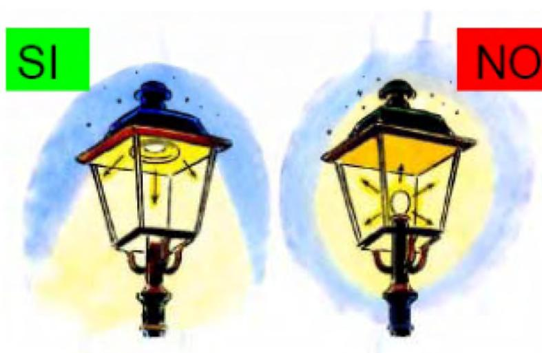
Lanterna "storica" schermata, a sinistra, e non schermata, a destra. La forma è identica ma nella prima la lampada è completamente incassata all'interno dell'armatura.
