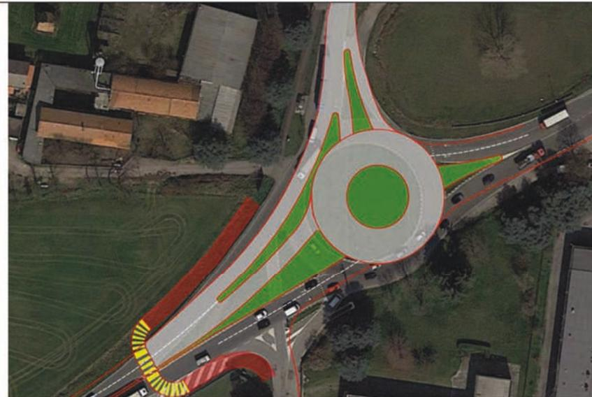
La stessa rotonda ridisegnata per massimizzare la capacità stradale con l'inserimento di una corsia di svolta continua risulterebbe non attraversabile in sicurezza e richiederebbe pertanto al realizzazione di un sottopasso.
