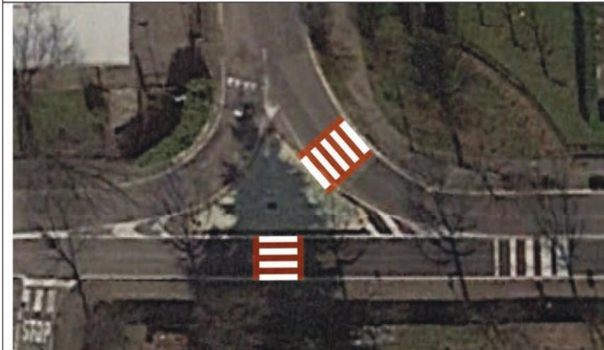
Come soluzione di minima occorre comunque riposizionare l'attraversamento in modo da renderlo più diretto e di consentire di attraversare una corrente alla volta sfruttando l'isola esistente.
