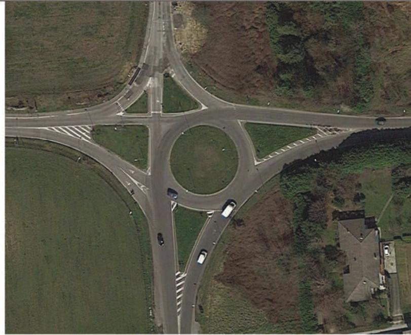
L'attraversamento della "rotatoria" a sud, realizzata in modo quantomeno curioso, è un punto di notevole criticità che rende in partica impossibile organizzare in sicurezza l'attraversamento del collegamento ciclabile che, si ricorda, deve anche cambiare tipologia (da percorso su strada moderata a pista bidirezionale in sede propria)
