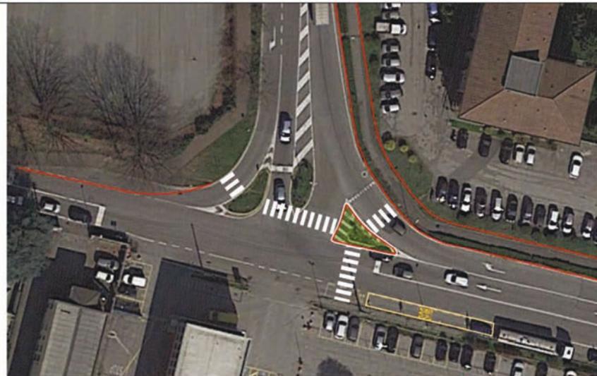
Si prevede di inserire gli attraversamenti pedonali, ampliando a tal fine una delle isole spartitraffico.
