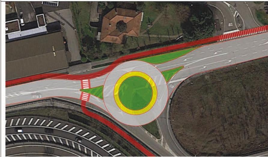
L'inserimento di una rotatoria, realizzabile con costi relativamente contenuti (usa unicamente il sedime attuale), oltre a rendere più sicuro ed efficiente il nodo consente di inserire un attraversamento protetto per il percorso ciclabile evitando l'attuale allungamento.
