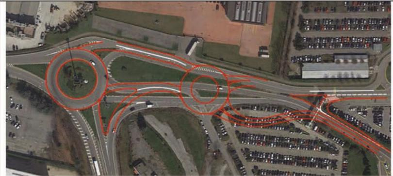
La proposta di ristrutturazione del nodo avanzata per il PGT è destinata a eliminare il primo problema. Anche la realizzazione del solo breve tratto di *shunt* dall'uscita del casello verso la STM, riducendo il flusso in ingresso in rotatoria, migliorerebbe la situazione.
